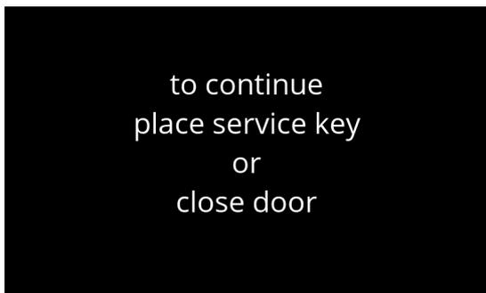
Wenn die Tür geöffnet wird, wird der Sicherheitsschalter aktiviert und eine Meldung angezeigt.
